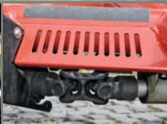
Kardáncsuklós tengelyre dolgoznak a egyéni hajtóművek, váltó nincs
