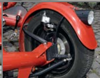
Dinamó és kis lámpák szolgáltatják a világítást. A jármű kerékpárnak minősül
