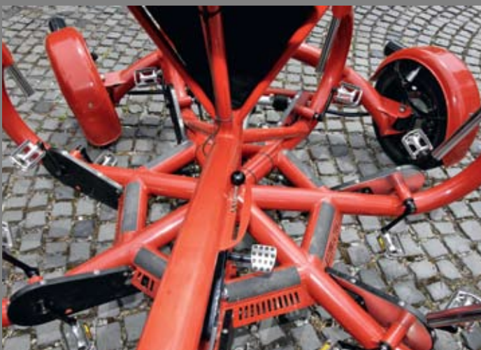
A főhely a vezetőé (a kép alja felől), ő működtetheti a pedálos hátsó féket, a káros kéziféket és a képen nem látható, szintén hidraulikus első tárcsaféket is
